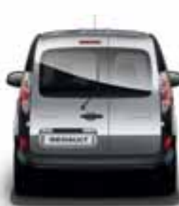
ZASTEKLJENA ASIMETRIČNA ZADNJA VRATA Z OGREVANIM STEKLOM IN BRISALCEM STEKLA
