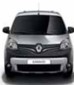
PREDNJI ODBOJNIK STYLE: DVOBOJNI ODBOJNIK MAT CRNE BOJE I U MAT KROMU, DODATNA SVJETLA I CRNA KUĆIŠTA SVJETALA
