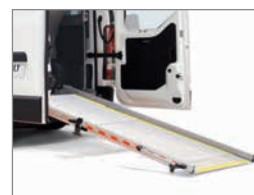
Rampe automatique 2 volets et abaissement coordonné du véhicule
